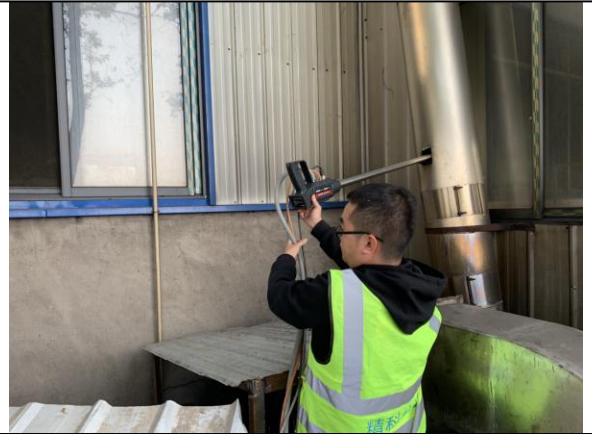
有组织废气出口采样照片
