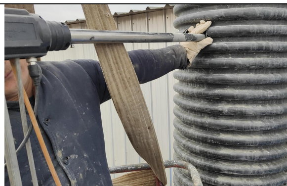
有组织废气出口采样照片
